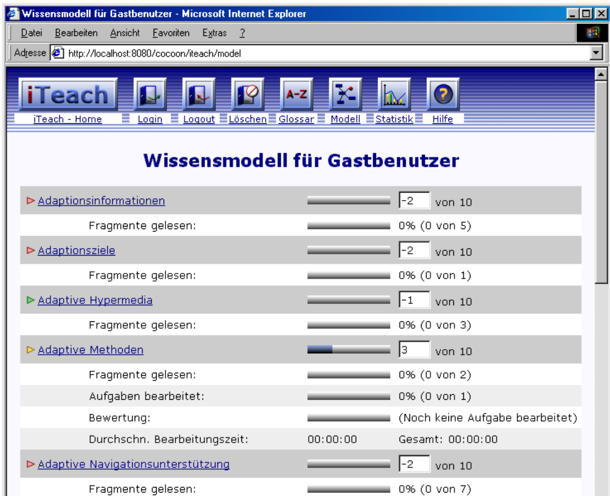
Abbildung 7.4: Die Ansicht des Benutzermodells. Zu beachten ist, dass der Wissensstand von Adaptive Methoden 3 beträgt, jedoch noch keine Inhalte präsentiert wurden. Dieser Zustand kommt entweder durch eine entsprechende Stereotypen-Initialisierung des Wissensmodells oder eine manuelle Aktualisierung des Benutzermodells zustande.
