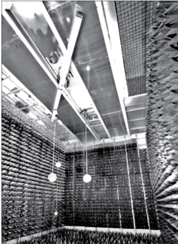
Abbildung 11: Der reflexionsarm ausgekleidete Tieftank (ohne Wasser).
